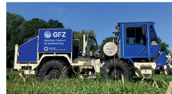
Vibro-Truck des GFZ mit sogenannten Rüttelplatten ©GFZ
